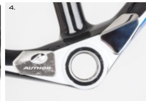
У модели AVION трос заднего тормоза конфигурации „V“ проходит внутри рамы. В этом случае салазки седла оснащены опорами для втулок тормоза конфигурации „V“.
